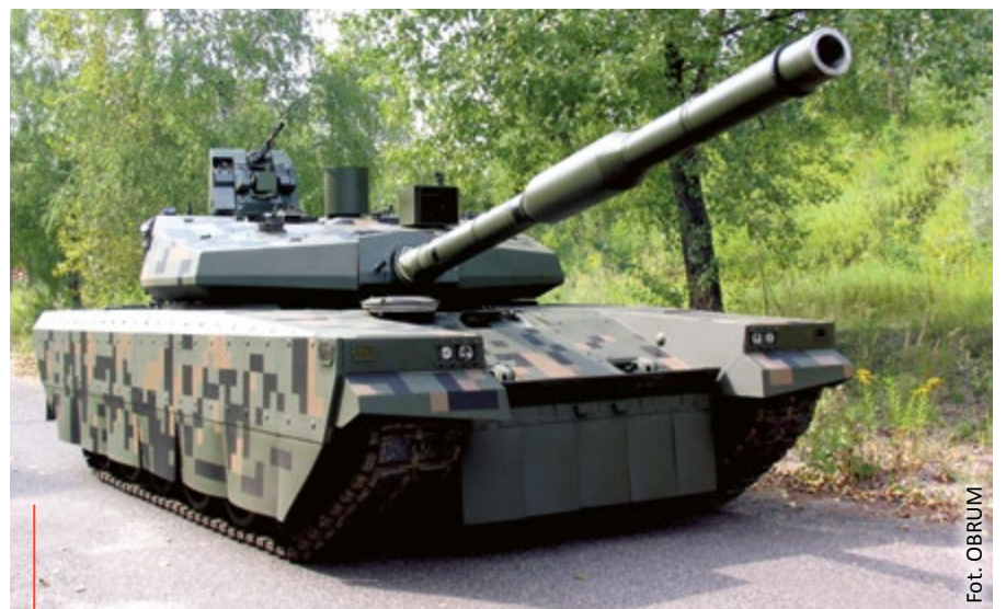
Czołg PT-16 czyli zmodernizowana wersja PT-91 „Twardy”
