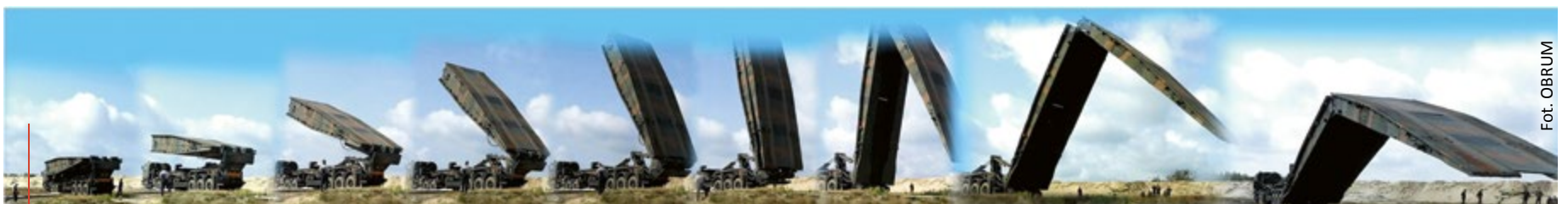
Tak rozkłada się wyprodukowany przez gliwicki „OBRUM” mobilny most wojskowy o kryptonimie „Daglezja”
