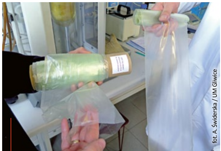
Próbki folii wyprodukowane z odzyskanego z tetrapaków polietylenu
