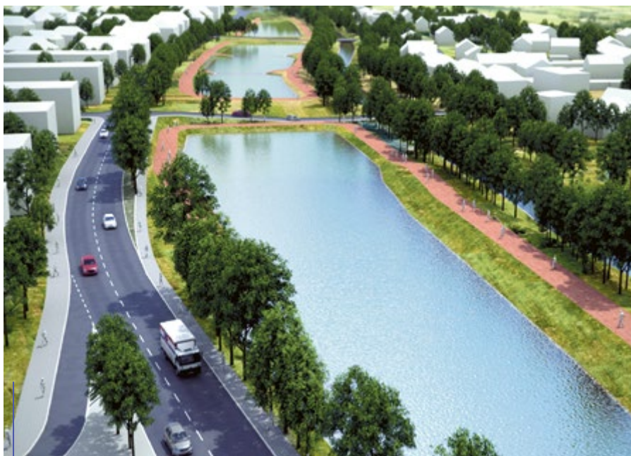
Tak będą wyglądać poldery po burzy, wypełnione wodą z Ostropki. System grobli i upustów zabezpieczy okoliczne budynki przed zalaniem
