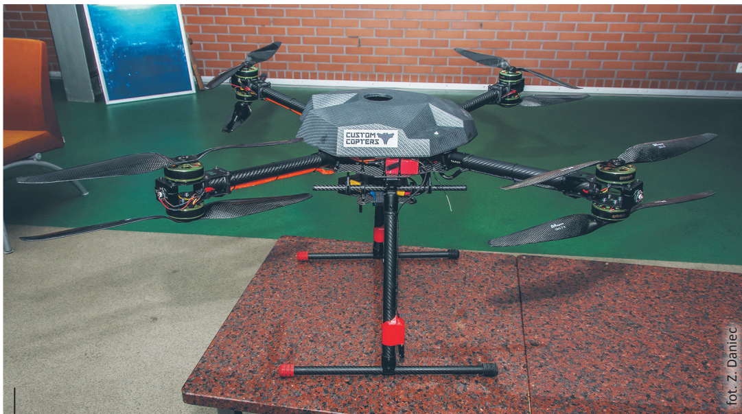
W Custom Copters powstały platformy octocopter CC-1 Illuminati i quadcopter CC-2 Kikker, stworzone m.in. w technologii druku 3D. Konstruktorzy rozpoczęli prace nad realizacją następnych pomysłów i prototypów. Tworzą drony spersonalizowane. Ich obsługi może nauczyć się każdy. I to w kilka minut
