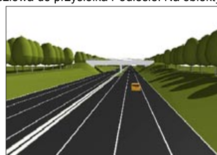
Droga w 4,5-metrowym wykopie
