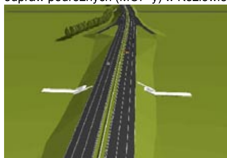
Droga na 14-metrowym nasypie
