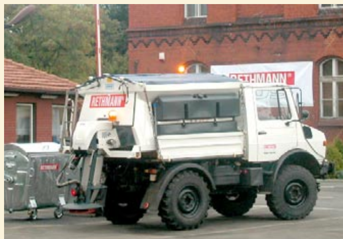
MERCEDES UNIMOG - samochód do odśnieżania z zamontowaną solarką
